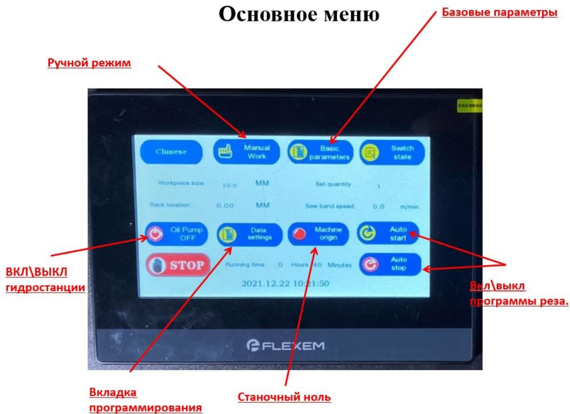
Рисунок 3. Основное меню ЧПУ ленточнопильного станка Metal Master MSK-350
