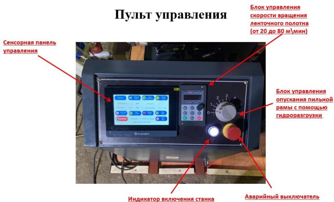
Рисунок 2. Пульт управления ленточнопильного станка Metal Master MSK-350
