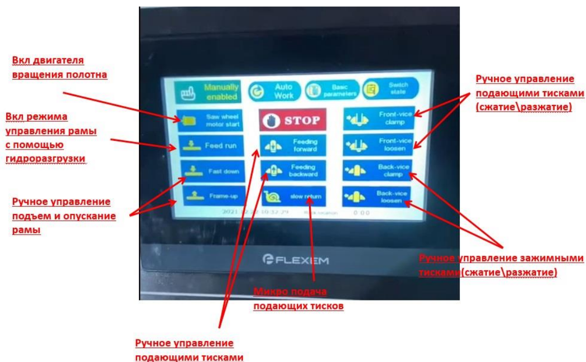
Рисунок 5. Меню программирования ленточнопильного станка Metal Master MSK-350
